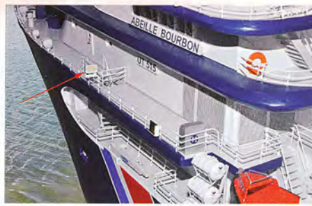
Le flanc bâbord où figure le projecteur latéral d'aide à l'accostage, ici marqué d'une flèche.
