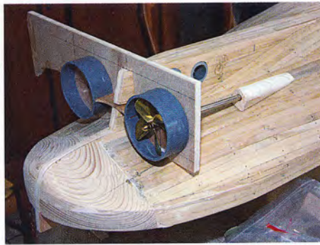
La mise en place des lignes d'arbres s'effectue à l'aide d'un gabarit de positionnement afin d'obtenir du premier coup une parfaite symétrie.
