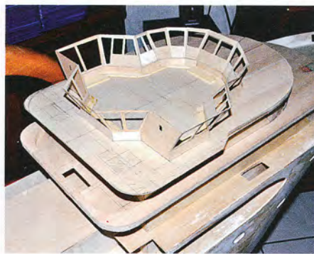
Les « casquettes » des ponts sont réalisées en balsa.
